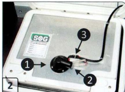
Bohrloch mit Silikon ausschmieren; Lüfter ① einsetzen, Schlauchanschluss ② am Lüfter, muss idealerweise entgegengesetzt zum SOG®-Anschluss im Deckel zeigen. Lüfter mit den Schrauben 3,5 x 16 mm (4 Stück) befestigen. Kabelsockel 25 x 25 mm ③ unterhalb des Lüfters anbringen (zur Zugentlastung). Zwei weitere Klebesockel anbringen und Kabel so wie auf dem Bild verlegen.
